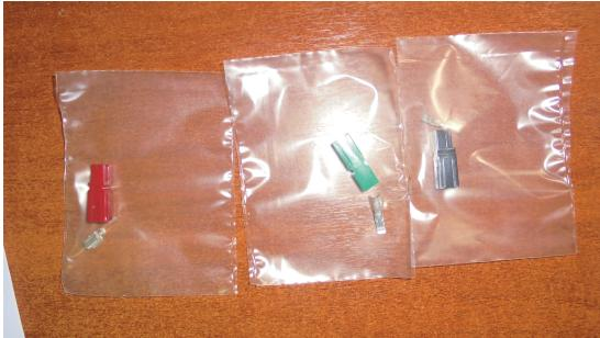
Разъём ANDERSON 45A под Провод ПВС 2x4/6 мм2
