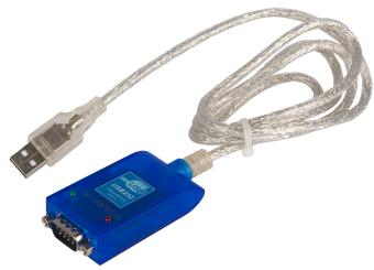
Кабель GL-MC-USB/RS232 позволяет подключится к RS-232 с помощью USB. Он обеспечивает внешний порт plug-and-play для удобного подключения сотовых телефонов, цифровых камер, модемов и терминалов ISDN. Этот смарт-кабель передает до 230 кбит / с с 96-байтовым буфером для потока данных по потоку и нисходящему потоку.
