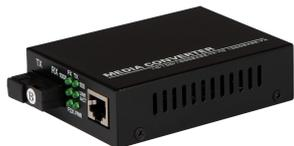
Медиаконвертеры GL-MC-UTPG-SC1G-08SM-1550-N и GL-MC-UTPG-SC1G-08SM-1310-N устанавливаются парой на разных концах линии связи. Также ответным устройством может быть любой конвертер или SFP-модуль с соответствующими характеристиками. Используют длину волны 1550 нм для приема данных и 1310 нм — для передачи, не поддерживает функцию LFP (Link Fault Passthrough), включающую оба порта медиаконвертера только в том случае, если на обоих портах есть сигнал от подключенного устройства.
