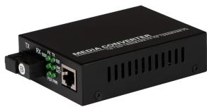
Конвертер GIGALINK из UTP, 10/100/1000Мбит/с в WDM, без LFP, SM, SC,
