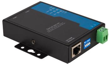
Преобразователь интерфейсов 2 порта RS232 — Ethernet (10/100M)
