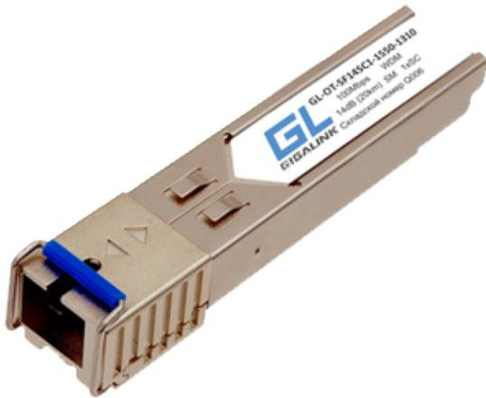
Модуль GIGALINK SFP, 100/155 Мбит/с, WDM, 1 OB, SM, 1xSC, Tx:1550/Rx:1310 нм, DDM, 14 дБ (до 20 км)
