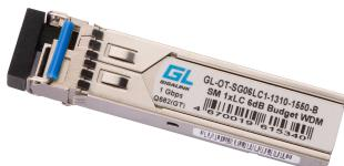
Модуль GIGALINK SFP, 1.25 Гбит/с, WDM, 1 ОВ, SM, 1xLC, Tx:1310/Rx:1550 нм, DDM, 6 дБ (до 3 км)
