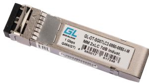
Модуль GIGALINK SFP, 1.25 Гбит/с, Duplex, 2 ОВ, ММ, 2xLC, Tx:850/Rx:850 нм, DDM, 7 дБ (до 550 м), -40 +85 °C
