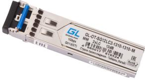
Оптический SFP модуль GL-OT-SG12LC2-1310-1310-M - продукт бренда GIGALINK, предназначенный для подключения удаленного участка сети по многомодовому волокну без необходимости использования дополнительного усилителя.
