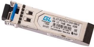
Оптический SFP модуль GL-OT-SG14LC1-1310-1550-D - продукт бренда GIGALINK, предназначенный для подключения удаленного участка сети по одномодовому волокну без необходимости использования дополнительного усилителя.
