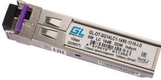
Модуль GIGALINK SFP, 1.25 Гбит/с, WDM, 1 OB, SM, 1xLC, Tx:1490/Rx:1310 нм, DDM, 14 дБ (до 20 км), -40 +85 °С
