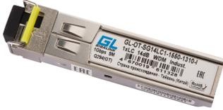
Модуль GIGALINK SFP, 1.25 Гбит/с, WDM, 1 OB, SM, 1xLC, Tx:1550/Rx:1310 нм, DDM, 14 дБ (до 20 км), -40 +85 °С
