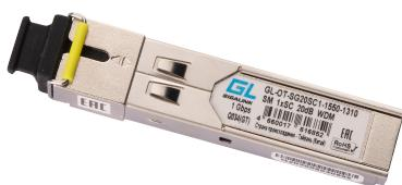
Модуль GIGALINK SFP, 1.25 Гбит/с, WDM, 1 ОВ, SM, 1xSC, Tx:1550/Rx:1310 нм, DDM, 20 дБ (до 40 км)
