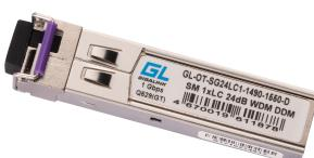
Модуль GIGALINK SFP, 1.25 Гбит/с, WDM, 1 OB, SM, 1xSC, Tx:1490/Rx:1550 нм, DDM, 24 дБ (до 80 км)
