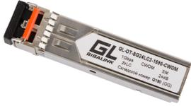
CWDM SFP модуль - это компактный сменный трансивер для организации передачи данных в сетях CWDM по протоколам Gigabit Ethernet, 1×Fibre Channel.
