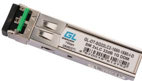
Модуль GIGALINK SFP, 1.25 Гбит/с, Duplex, 2 ОВ, SM, 2xLC, Tx:1550/Rx:1550 нм, DDM,
