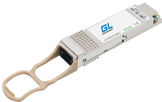
Модуль GIGALINK QSFP+, 40 Гбит/с, MM, MPO12, Tx:850/Rx:850 нм, DDM, 1.9 дБ (до 400 м)
