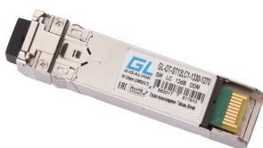
Модуль GIGALINK SFP28, 25 Гбит/с, WDM, 1 OB, SM, 1xLC, Tx:1330/Rx:1270 нм, DDM, 6.3 дБ (до 20 км)
