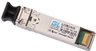
Модуль GIGALINK SFP28, 25 Гбит/с, Duplex, 2 OB, SM, 2xLC, Tx:1310/Rx:1310 нм, DDM, 12 дБ (до 10 км)
