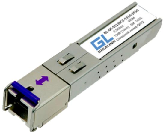
Модуль GIGALINK SFP, 2.5 Гбит/с, WDM, 1 ОВ, SM, 1xSC, Tx:1550/Rx:1310 нм, DDM, 13 дБ (до 20 км)
