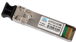
Модуль GIGALINK SFP+, CWDM, SM, 2xLC, 14dB, DDM
