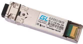
Модуль GIGALINK SFP+, 10 Гбит/с, WDM, 1 OB, SM, 1xLC, Tx:1330/Rx:1270 нм, DDM, 21 дБ (до 60 км)
