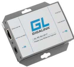
Инжектор запитывает сетевое устройство по витой паре. Он подключается к Ethernet кабелю и отдельно к электрической розетке, на выходе дает передаваемые по обычной витой паре данные и PoE питание. Блок питания в комплект не входит.
