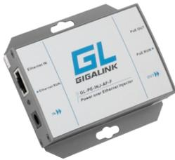
Инжектор запитывает сетевое устройство по витой паре. Он подключается к Ethernet кабелю и отдельно к электрической розетке, на выходе дает передаваемые по обычной витой паре данные и PoE питание. Поддерживает скорость до 1000Мбит/с. Блок питания приобретается отдельно.
