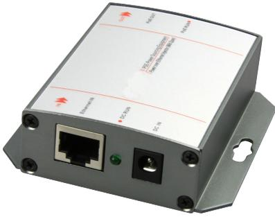
Однопортовый высокомощный гигабитный PoE-инжектор, 2 порта 10/100/1000Мб/с RJ45, порт питания имеет молниезащиту (соответствует вторичной молниезащите), питание передается по четырем парам, 1/2, 4/5 линиями является положительной стороной питания, а пара 3/6, 7/8 - отрицательной стороной питания
