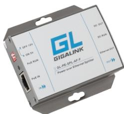
Сплиттер используется для питания в PoE сетях устройств, не поддерживающих этот стандарт. Он подключается к PoE сети и выделяет из нее отдельно электрическую составляющую, а отдельно — данные. Поддерживает скорость до 1000Мбит/с.
