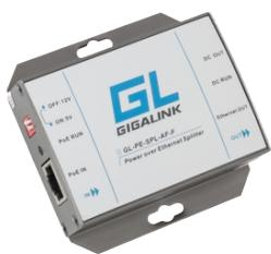
Сплиттер используется для питания в PoE сетях устройств, не поддерживающих этот стандарт. Он подключается к PoE сети и выделяет из нее отдельно электрическую составляющую, а отдельно — данные.
