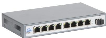
GL-SW-F000-08F — неуправляемый коммутатор FastEthernet, оснащенный 8-ю портами 10/100 Base-TX и одним слотом SFP для установки модулей 100 Мбит/с. Это предельно бюджетное решение, сочетающее в себе коммутатор и конвертер, поддерживает VLAN и позволяет изолировать медные порты друг от друга, разрешив им передавать данные только в порт SFP. Данный режим включается при помощи механического переключателя на передней панели устройства.
