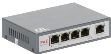
Неуправляемый коммутатор GIGALINK, с 4 портами из них 1 и 2 порт могут выдавать до 60Вт на порт. Пятый порт не оснащен PoE и используется для соединения с другими устройствами сети. Суммарная мощность PoE не более 120Ватт
