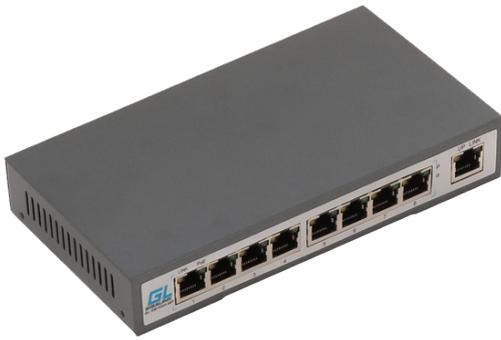
Бюджетные восьмипортовые PoE-коммутаторы помогут запитать WiFi-точки, IP-камеры и IP- телефоны. Восемь портов Fast Ethernet могут использоваться для линий с шириной канала до 100 Мбит/с. Суммарная мощность PoE не более 240Ватт
