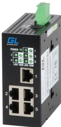
Идустриальные коммутаторы полупрофессиональной серии необходимы там, где требуется надежность и производительность сети. Малопортовые коммутаторы благодаря компактным размерам экономят место в коммутационном или электротехническом шкафу. Обладают креплениями для установки на стену и на DIN-рейку. Степень защиты IP40
