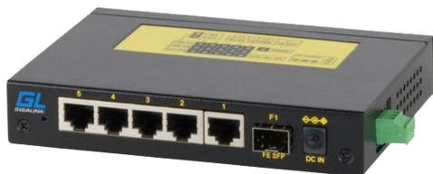
Неуправляемый, промышленный на DIN рейку, 4 x 10/100 Мбит/с, 1 комбо RJ45/SFP 100Base-FX, питание 12-24В, 10 Ватт (питание поставляется отдельно)
