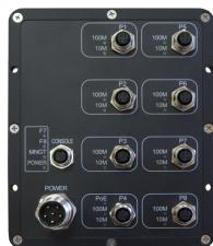
8-портовый управляемый коммутатор, с поддержкой питания по PoE, с разъемами M12 8x 10/100 Мбит /, из которых 2x порта Combo M12 или 2x LC SMF 20km, питание 12В (блок питания поставляется отдельно 30 Ватт) либо PD (30Ватт)
