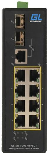
Индустриальные L2 управляемые коммутаторы от GIGALINK GL-SW-F203-08PSG-I поддерживают различные функции STP/RSTP в том числе TurboRing/Turbo Chain/Управление питанием PoE/ автоопределение/ планировщик расписания по питанию/ диагностика/ управление скоростью по портам и зеркалирование портов, IGMP/ VLAN/ QoS/ RMON/. Могут работать в самых жестких условиях и выдавать питание PoE до 30Ватт. Суммарная мощность 240 Ватт. Устанавливается на DIN-рейку или на стену. Защита корпуса IP40.
