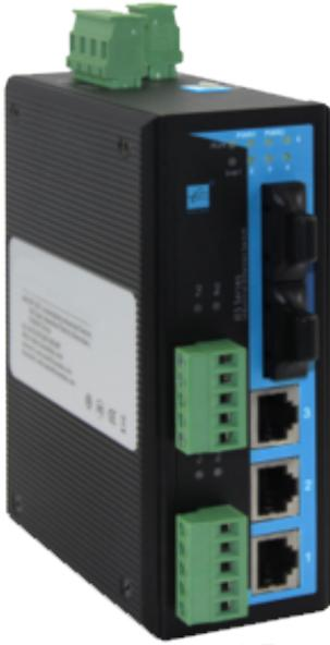
Преобразователь интерфейсов 3 порта 10/100Мбит/с Base-T, 2 SFP и 2 RS-485 предназначен для быстрого подключения к сети ваших устройств. Является идеальным выбором для подключения децентрализованных последовательных устройств к сети, что позволяет легко и удобно управлять устройствами. Он поддерживает протоколы ARP, ICMP, TCP, UDP, DHCP, DNS, HTTP, SW-Ring, RSTP, SNMP и Windows Native COM, LLF.
