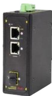
Индустриальные неуправляемые коммутаторы GL-SW-G001-02PSG-I от GIGALINK могут работать в самых жестких условиях. Коммутаторы содержат 2 RJ-45 порта PoE (IEEE 802.3af/at) и 1 порт SFP, поддерживающих скорость работы до 1000Мбит/с. Предназначен для крепления на DIN-рейку или стену. Бюджетные коммутаторы GL-SW-G001- 02PSG-I отлично подходят для построения корпоративных сетей малого размера. Степень защиты IP40
