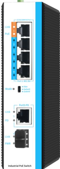
Коммутатор GIGALINK, неуправляемый, индустриальный на DIN рейку, 4 PoE (802.3af/at/BT) порта 1Гбит/с, 1 x SFP/1000Base-X, 1 x 1000Base-T (PD 60Вт), питание 48В (блок питания поставляется отдельно 60-120 Ватт) либо PD
