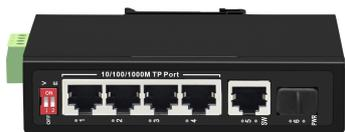
Индустриальные коммутаторы GL-SW-G005-06SG-I от GIGALINK могут работать в самых жестких условиях, этому способствует защита корпуса IP40. Поддерживает стандарты IEEE802.3, IEEE802.3u, IEEE802.3i, IEEE802.3ab, IEEE802.3z. Устанавливается на DIN-рейку или на стену.
