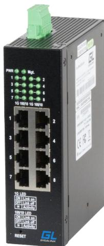
Индустриальные L2 управляемые коммутаторы GL-SW-F202-08-I от GIGALINK могут работать в самых жестких условиях. Коммутаторы содержат 8 RJ-45 портов, поддерживающих скорость работы до 1000Мбит/с. Установка на DIN-рейку или на стену. Поддерживаемые функции и протоколы: VLAN, QoS, Port Control. Удаленное управление: SNMP/Telnet/Web.
