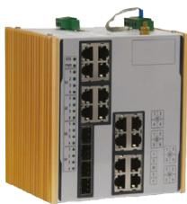
Коммутатор GIGALINK, L2 управляемый, индустриальный, 16 1000Mbps Base-T, 4 combo RJ45/SFP 1000Mbps, питание 12-24В (блок питания поставляется отдельно 30Ватт)
