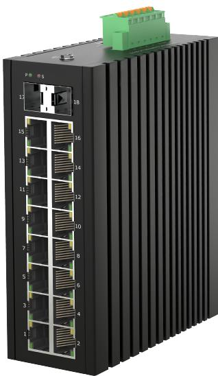
Управляемый промышленный L2 коммутатор GIGALINK, 16\*10/100/1000Мбит/с PoE (af/at), 2\*1/2.5/10Гбит/с SFP+, Крепление на DIN-рейку, 2\*ввода питания, питание 44-57В (блок питания 240Вт поставляется отдельно), -40С +75С.
