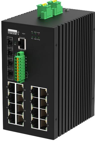
Управляемый промышленный L2+ коммутатор GIGALINK, 16\*10/100/1000Мбит/с PoE (af/at), 4\*1/2.5/10Гбит/с SFP+, Крепление на DIN-рейку, 2\*ввода питания, питание 44-57В (блок питания 370Вт поставляется отдельно), -40С +70С.
