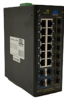
Коммутатор GIGALINK, L2+, индустриальный на DIN рейку, 12x10/100/1000Мбит/с (1-8 PoE af/at), 8x1000Мбит/с SFP, 4x10Гбит/с SFP+, 1 Консольный RJ-45, питание 48В (блок питания поставляется отдельно 480 Ватт)
