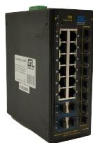
Коммутатор GIGALINK, L2+, индустриальный на DIN рейку, 12x10/100/1000Мбит/с (1-8 PoE af/at), 8x1000Мбит/с SFP, 4x10Гбит/с SFP+, 1 Консольный RJ-45, питание 48В (блок питания поставляется отдельно 480 Ватт)
