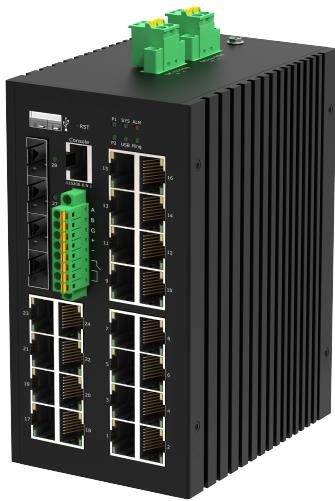
Управляемый промышленный L3 коммутатор GIGALINK, 24\*10/100/1000Мбит/с PoE (af/at/BT) из которых 4 порта PoE BT, 4\*1/2.5/10Гбит/с SFP+, Крепление на DIN-рейку, 2\*ввода питания, питание 44-57В (блок питания 370Вт поставляется отдельно), -40С +70С.
