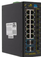
Коммутатор GIGALINK, L3, индустриальный на DIN рейку, 12x10/100/1000Мбит/с (1-8 PoE af/at), 8x1000Мбит/с SFP, 4x10Гбит/с SFP+, 1 Консольный RJ-45, питание 48В (блок питания поставляется отдельно 480 Ватт)
