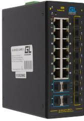
Коммутатор GIGALINK, L3, промышленный на DIN рейку, 12x10/100/1000Мбит/с (1-8 PoE af/at), 8x1000Мбит/с SFP, 4x10Гбит/с SFP+, 1 Консольный RJ-45, питание 48В (блок питания поставляется отдельно 480 Ватт)
