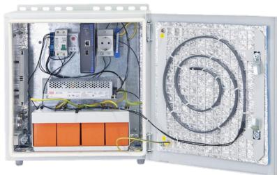
Многофункциональный управляемый PoE коммутатор 150 Ватт на 10 портов из них 2 порта 802.3BT с термоустойчивостью и резервным питанием на 4 АКБ 9Ач в промышленном исполнении IP66 с оптической развязкой Duplex на 20 км, сплайс-кассета до 32 КДЗС доукомплектована крышкой.
