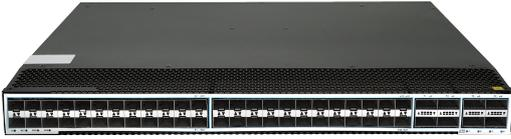
Коммутатор ядра сети GL-SW-X305-56SQ – продукт бренда GIGALINK уровня L3, предназначенный для соединения нескольких устройств локальной вычислительной сети (LAN) или нескольких сегментов данной сети.
