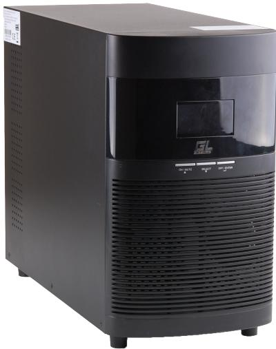
Источник бесперебойного питания On-Line, Tower, 1 фаза 3000ВА/2700Вт, 72В, ток заряда 8А, без батарей(внешние)
