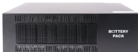
Дополнительный блок батарей для источников бесперебойного питания GIGALINK GL-UPS-OL06pf-1-1 и GL-UPS-OL10pf-1-1, повышает емкость и время автономной работы системы. Укомплектован двадцатью батареями 12В 9А. Также батарейный блок может поставляться без батарей.
